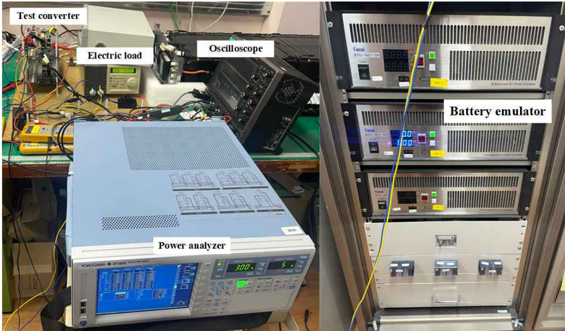
그림 4.2. 배터리 균등화 회로 실험 장비 구성.
